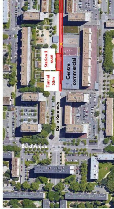
L'aiguillage permettant de passer d'une voie à l'autre se situe en avant-gare, limitant le temps de retournement des rames à 81s. Ce n'est pas le cas au terminus La Poterie configuré en arrière-gare.
